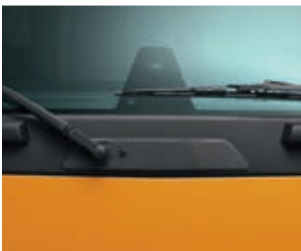
→ Sicherheitssensoren Ultraschall-Präsenzsensoren erkennen ungeschützte Verkehrsteilnehmer auf der Beifahrerseite. Die Warnung erfolgt über eine visuelle (LED) und Audio-Anzeige.
