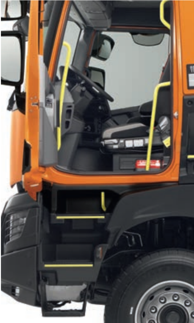
→ Gelb lackierte Trittstufen / Handgriffe Erhöhen die Sicherheit beim Betreten und Verlassen des Fahrerhauses.
