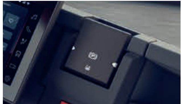
→ Notaktivierung der Feststellbremse Wegfahrsperrung wird bei offener Fahrertür aktiviert.
