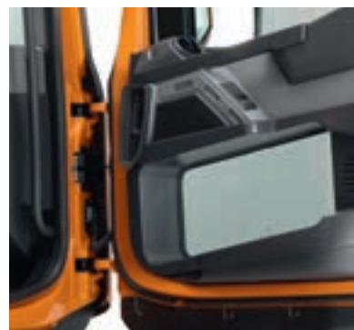
→ Türsichtfenster An der Beifahrertür befindet sich ein zusätzliches Sichtfenster auf Höhe von Radfahrern und Fussgängern.
