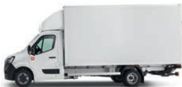
→ VERSION CAISSE 20 ou 22 m 3 avec hayon 4 vérins 750 kg, déflecteur ou capucine*.
