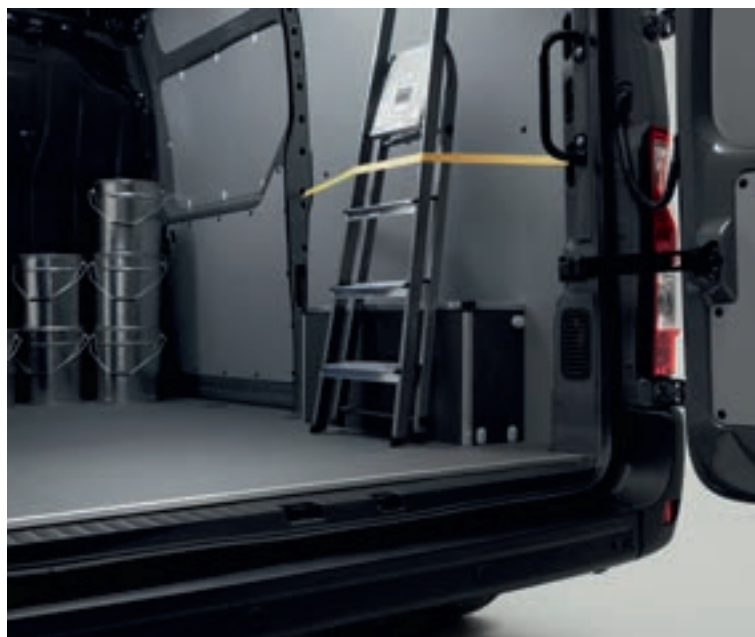
Parois latérales et plancher antidérapant polypropylène 6 mm
