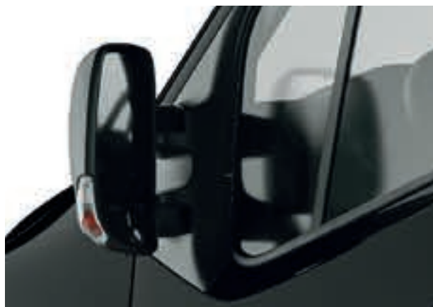
2 RÉTROVISEURS GRAND ANGLE à réglage électrique avec clignotants intégrés.
