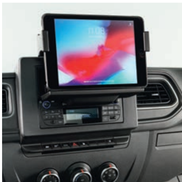
SUPPORT TABLETTE RÉTRACTABLE intégré dans la planche de bord pour des documents A4.
