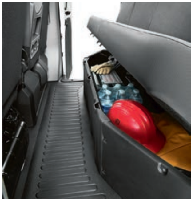
STAUFÄCHER UNTER DER RÜCKSITZBANK durch klappbare Sitzfläche in der Ausführung mit doppeltem Fahrgestell.
