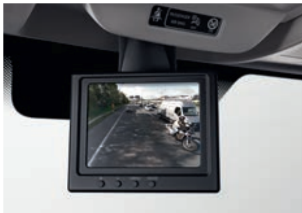
3 PERMANENTE SICHT NACH HINTEN durch die Kamera hinten am Dach, die beim Fahren den Blick in den Innenspiegel ersetzt.
