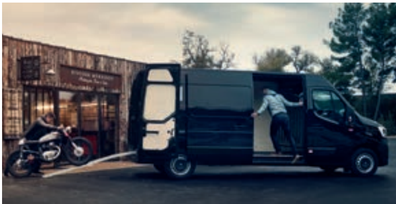
SEITENTÜR LÄSST SICH BIS 1270 MM ÖFFNEN zur Beladung einer Europalette.
